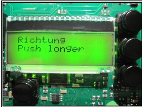
Falls Sie die Taste nicht lange genug eingedrückt haben, erscheint diese Meldung. Die Steuerung braucht ein mindestzeit zum kontrollieren ob 1 oder 2 Kanäle der Encoders angeschlossen sind.
