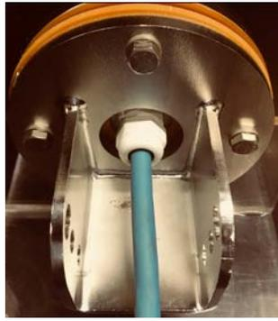
Kabelverschraubung in den Flansch
