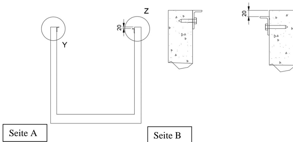
Montieren Sie das L-Profil 60x30mm auf Seite A in der gleichen Höhe wie der Boden des Beckens (ohne Verkleidung)
