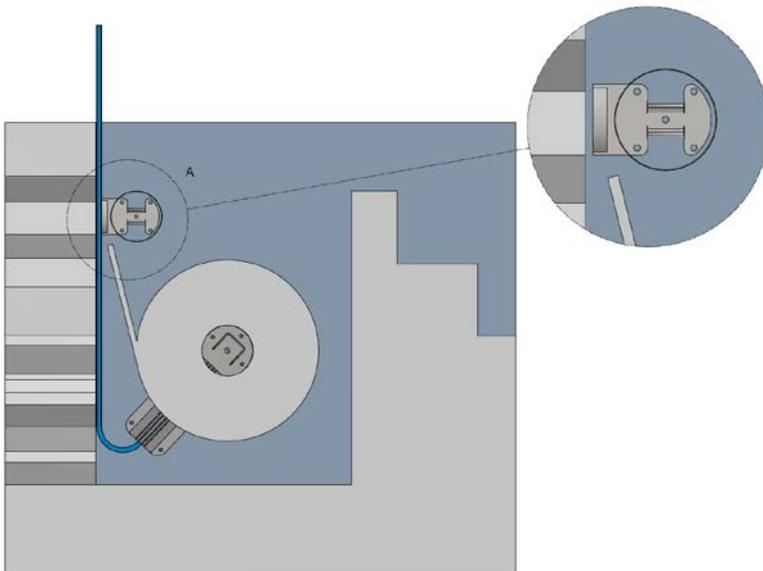
Falls Sie einen Rohrmotor verwenden mit Befestigungsbügel für Montage am oder im Beckenboden, wird einer Sonderflansch mitgeliefert für die Montage vom Rohr (Ø139,7mm). **Auf diesem Flansch ist eine Führung für die Lamellen gemacht . ACHTUNG: Der Sonderflansch soll immer an der Motorseite montiert werden !!!**
