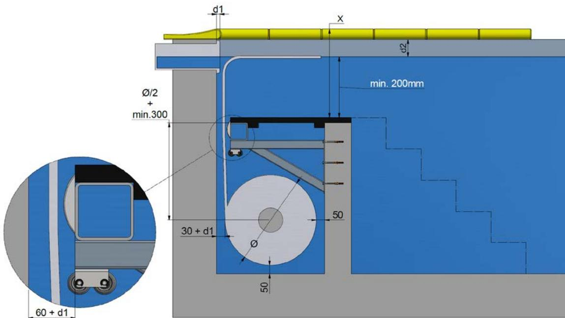
Falls der Relaxbereich als erste Stufe einer Treppe verwendet wird, soll  $X \leq 400\text{mm}$  !
