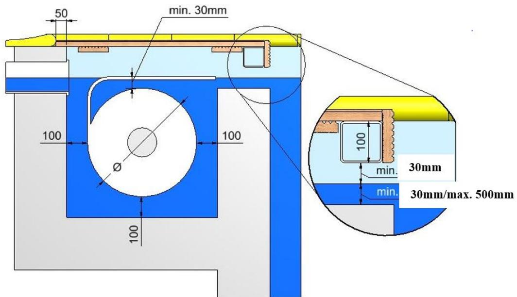
**Aluminium Sturzbalken 110x65mm (anodisiert 25µm)**
