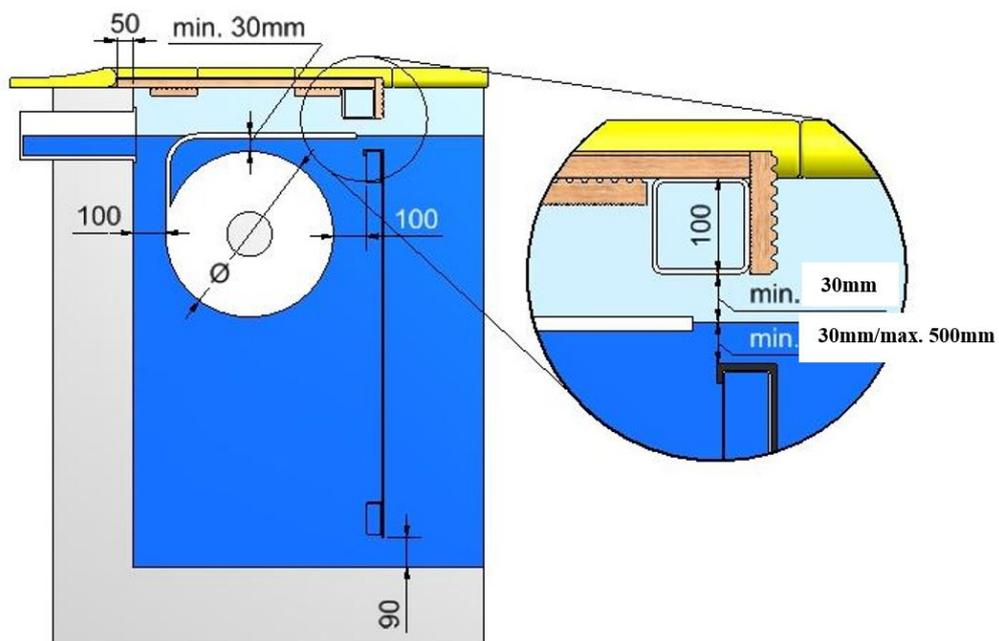
**Aluminium Sturzbalken 110x65mm (anodisiert 25µm)**
