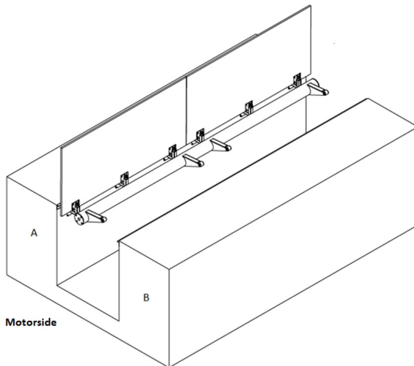
In dieser Anleitung betrachten wir immer die Nische von der Motorseite und gehen davon aus, dass die bewegliche Klappe auf der Seite A montiert wird.
