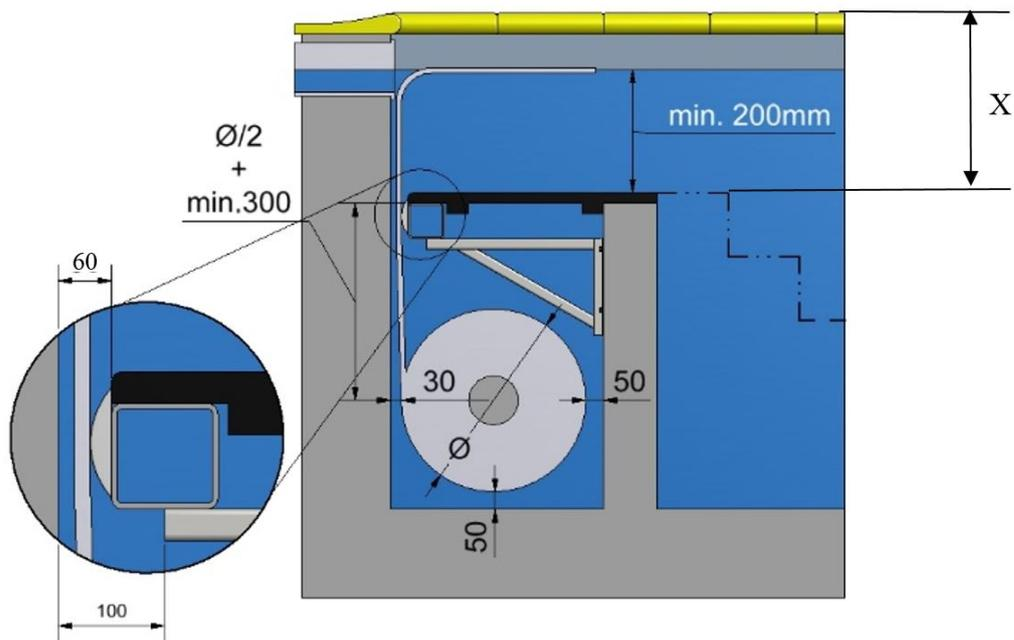
Falls der Relaxbereich als erste Stufe einer Treppe verwendet wird, soll  $X \leq 400\text{mm}$  !
