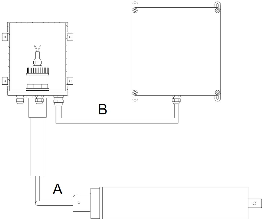
Kabel A :     Blaues Kabel am Motor montiert. Länge 10m
