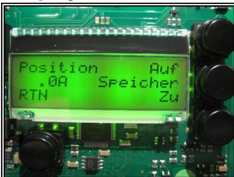
T1 drücken bis die Abdeckung offen ist. Um die AUF Position zu speichern, erst T2 drücken, anhalten und gleichzeitig T1 drücken. Die Bestätigung erscheint auf den LCD Schirm. T3 drücken bis die Abdeckung geschlossen ist. Um die ZU Position zu speichern, erst T2 drücken, anhalten und gleichzeitig T3 drücken. Die Bestätigung erscheint auf dem LCD Schirm.
