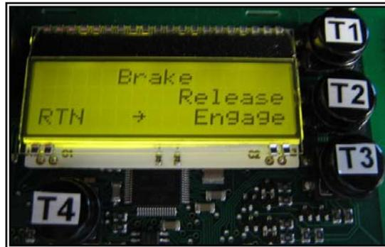
**Bremse frei (T2):** Der Motor wird nicht gebremst.
