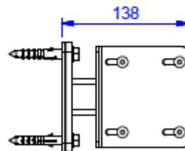
Um die Platten an den Scharnieren anzubringen, platzieren sie zunächst die Platte in der richtigen Position auf den Scharnieren.
