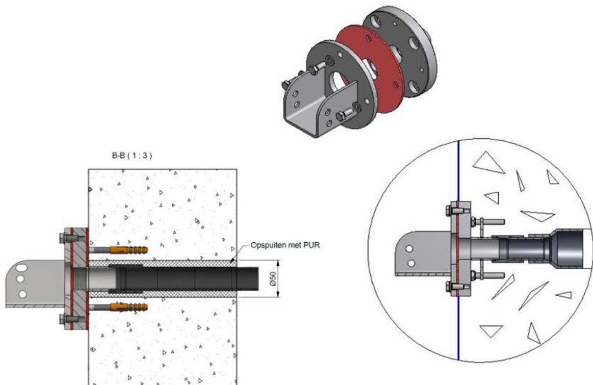
Bohren Sie ein 50mm Loch. Nach dem Platzieren des Kanals mit PUR sprühen, um eine Beschädigung des PVC-Schutzrohrs zu vermeiden.
