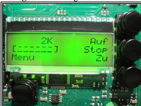
Die Abdeckung ist BEREIT für Gebrauch. Um die Endpositionen oder andere Einstellungen zu ändern, siehe "E4 – Einstellen des Antriebs: Externer Motor & Rohrmotor (Universelle Steuerung) 3. Erweiterung".
