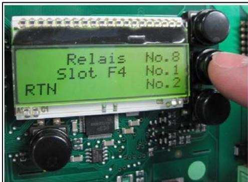
**RELAIS auswählen worauf Sie das Pneumatikventil angeschlossen haben (Falls Sie das laut Plan gemacht haben geht es um Relais 1)**
