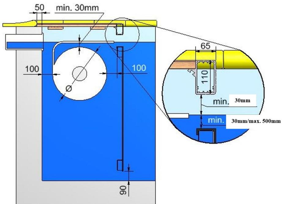
**Bügel mit Rollen für hohen Wasserstand (L = 770/950/1200mm)**
