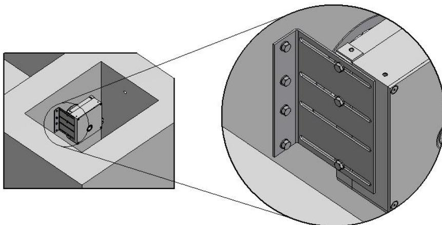
Option: Bei ein Folienbecken ist da ein Risiko die Folien beschädigt wird falls die Abdeckung blockiert. Om di Folien zu schützen schlagen wir vor eine Schutz auf die Durchführung zu montieren. Diese wird mit Silikon befestigt.
